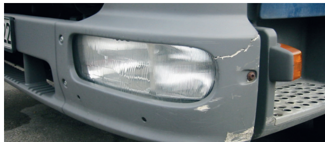
✗ Pare-chocs/Dommages importants • Fortes éraflures, fissures ou cassure
