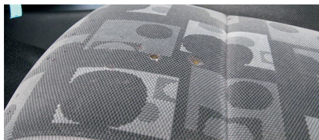
✗ Sièges/ Dommages importants • Trous de brûlures, déchirures
