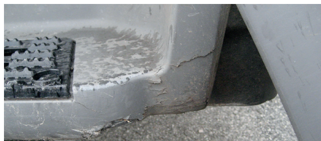
✗ Marchepied / Dommages importants • Rayures profondes, partie manquante ou fissures
