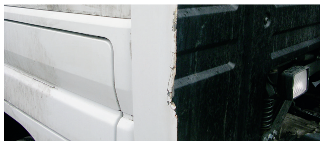
✗ Défecteur d'air / Dommages importants • Rayures, fissures ou cassure
