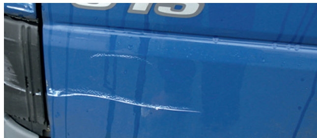
✗ Portes/ Dommages importants • Peinture fortement dégradée
