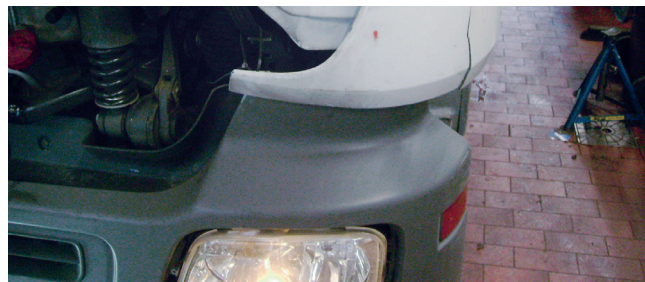
✗ Défecteur de vent / Dommages importants • Rayures, fissures, ou fracture
