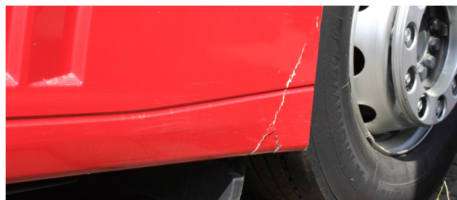
✗ Bandes de protection latérales /Dommages importants • Rayures, fissures ou cassure
