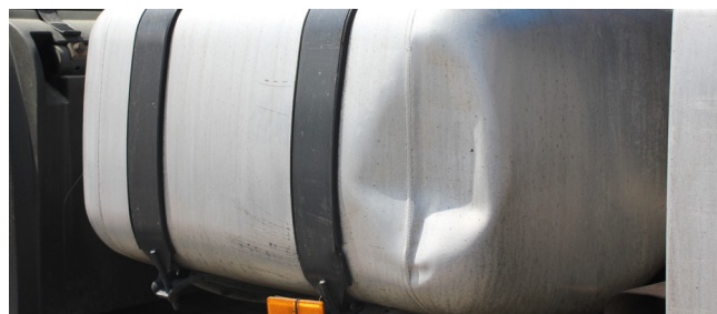
✗ Réservoir de carburant / Dommage important • Déformation
