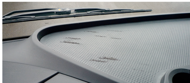
✗ Console avant/ Dommages importants • Rayures profondes, gros trous, trous de perçage
